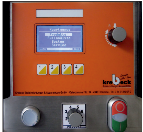
Steuereinheit der Absackwaage, mit Programm-Schnellwechsel-Schalter
